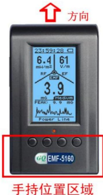
为了获得尽可能准确的读数，请始终将仪表的顶部（传感器）指向信号源。
